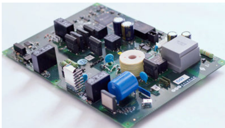
OEM-Defibrillationsmodul BDM75 von Corscience – biphasische Impulsform für höchste Wirksamkeit bei niedrigen Energien.
